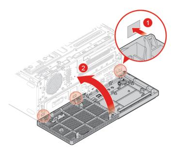
Figure 25. Installing the front bezel
